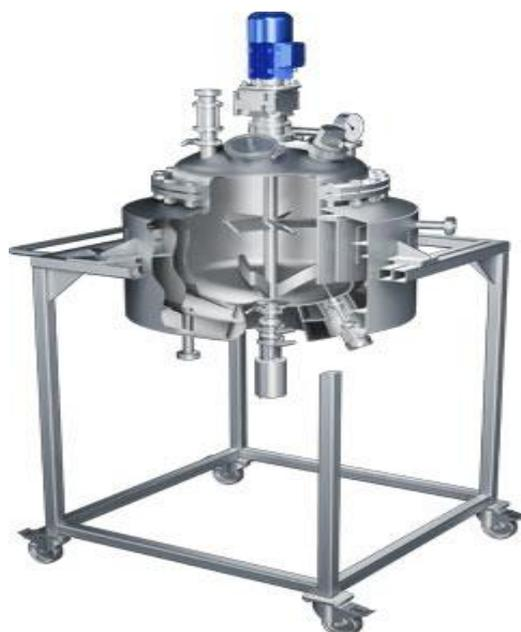
Рис. 15. Лабораторный 10 л химический реактор из нержавеющей стали. Расположение перемешивающего устройства – вертикальное; установленная мощность 3,0–45 кВт; скорость вращения мешалки, 0–18000 об/мин; основной материал сталь 12Х18Н10Т или AISI 316; рабочее давление пара в рубашке 0,2–0,4 МПа; рабочее разрежение пара в корпусе аппарата – до 0,03 МПа
